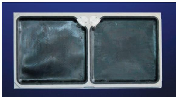
Горизонтальная мембранно-камерная плита 2000 x 1000 мм
