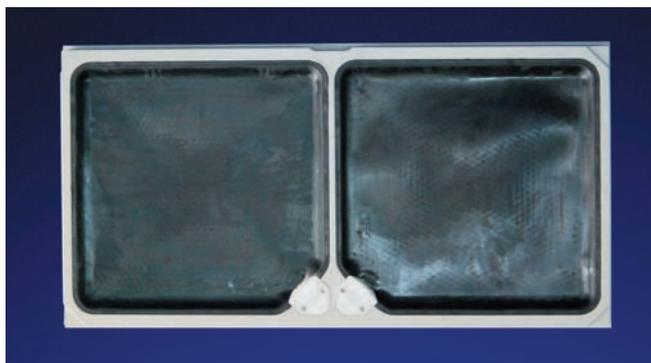
Горизонтальная мембранно-камерная плита 2000 x 1000 мм
