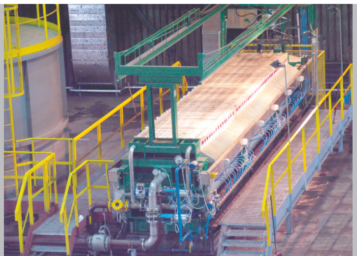
Filterpresse mit Membran- und Kombinationskammerplatten aus PVDF 1200 x 1200 mm
